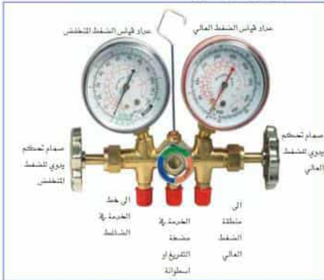
شكل (4-2) عدادات الضغط (المانفولد)
