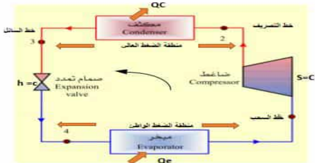
شكل 1 : مخطط الانسياب (Flow diagram) لدورة التبريد
