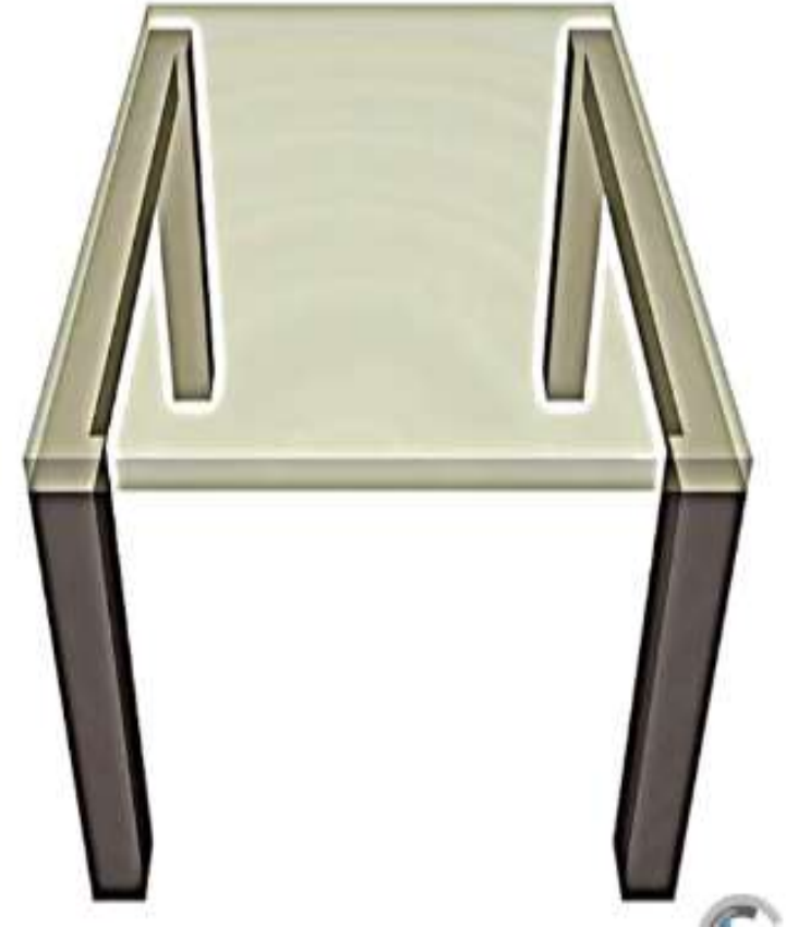
بلطة احادية الاتجاه (One way slab)
