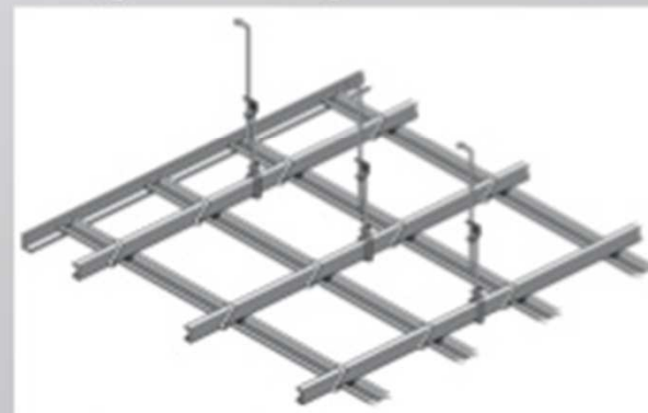
التعليق باستخدام wires
