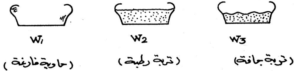
شكل (٢-٧) قياس محتوى الرطوبة للتربة بالتجفيف
