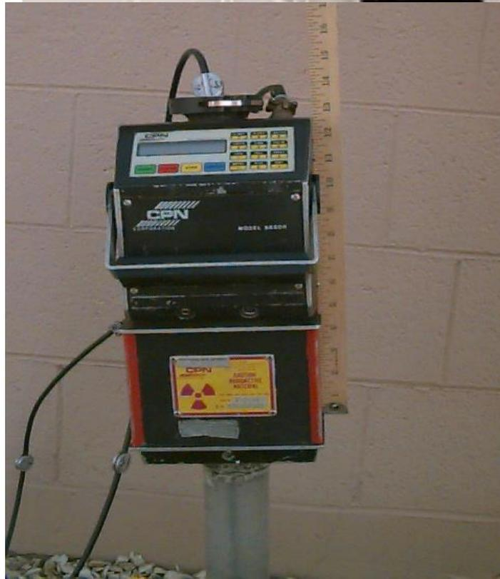
صور توضح المجس وجهاز تقدير رطوبة التربة بطريقة تشتت النيوترونات
