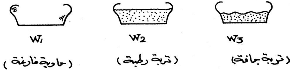
شكل (٢-٧) قياس محتوى الرطوبة للتربة بالتجفيف
