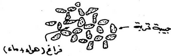
شكل (١-٢) مكونات كتلة التربة
