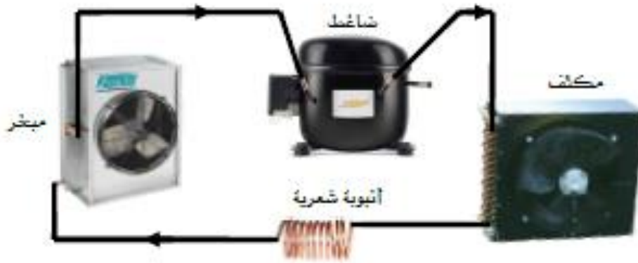
الشكل (4-2): دورة تبريد تستخدم أنبوية شعرية.
