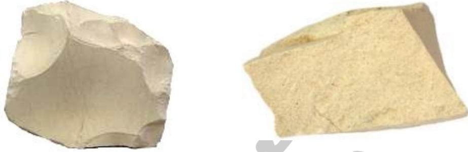
يتكون معظمها من معدن الكالسيت ( $\text{CaCO}_3$  - Calcite) حيث يترسب في البحار والمحيطات أو البحيرات بفعل تبخر المياه أو في الكهوف والمغارات بعد فقدان غاز ثاني اوكسيد الكربون ( $\text{CO}_2$ ) وعلى شكل سنلكتايت وستلكتايت (Stalactite and Stalagmite).
