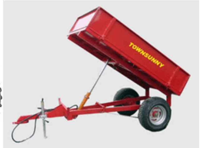
الشكل (35) استغلال المنظومة الهيدروليكية في رفع الآلات وصناديق العربات
