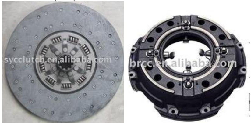
الشكل ( 24 ) قرص الضغط الشكل ( 23 ) قرص الاحتكاك
