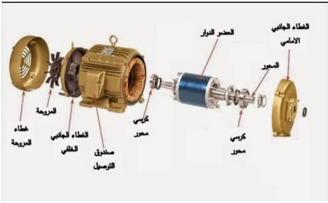
الشكل (12.2): الاغطية الجانبية مع باقي اجزاء المحرك
