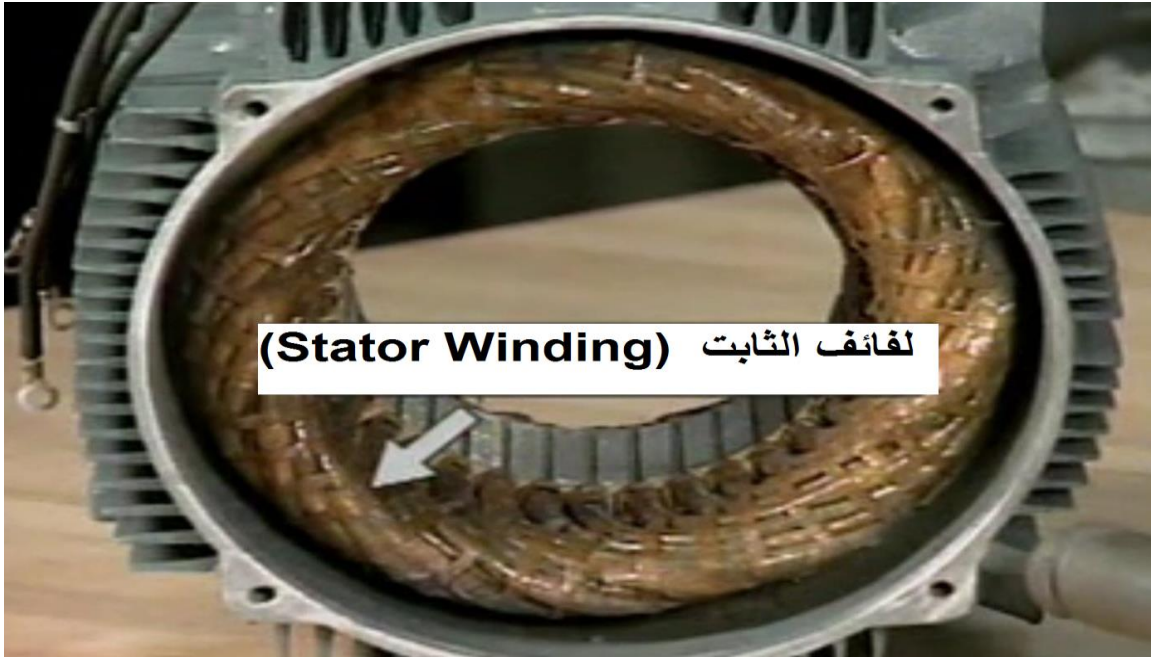
الشكل (4.2): لب ولفائف الجزء الثابت عمليا في الواقع
