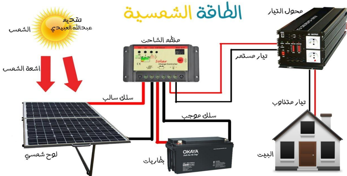
شكل مبسط يوضح شكل المنظومة الشمسية المعزولة عن الشبكة الكهربائية
