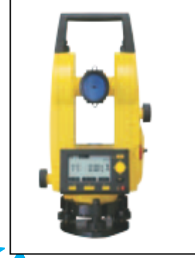
الشكل (9) تسامت ورموز وشكل الجهاز (نوع Builder T100) وشاشته الرقمية
