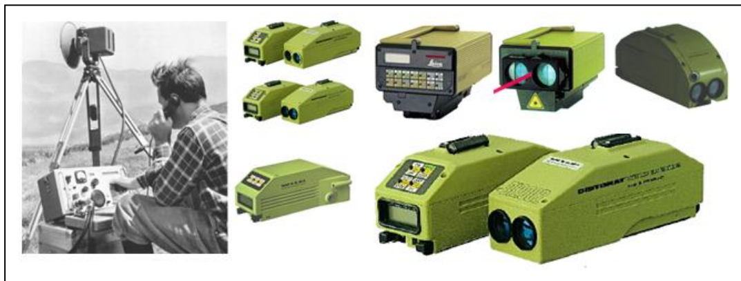
الشكل (43) أنواع مختلفة من أجهزة قياس المسافات إلكترونياً (EDM)
