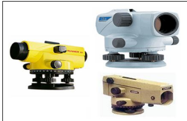
الشكل (٤) أجهزة تسوية، القهواني (Parallel plate micrometer GPM 3)، الرصاصي (Sokkia Automatic level)، الأصفر (Runner 20)، الأحمر صيني
