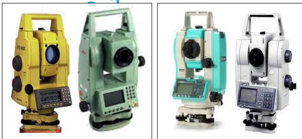
الشكل (21) من اليمين جهاز سوكيا (T.S Sokkia Set 3110 ) ثم نيكون (T.S Nikon DTM 302 ) ثم جهاز (T.S Leica T.C 700 ) ثم جهاز (T.S Topcon GTS 800 )
