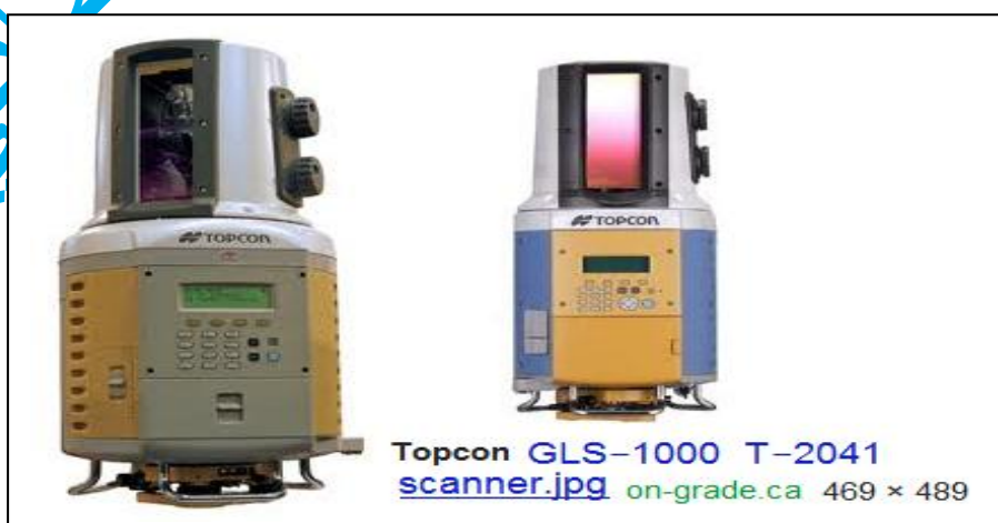
الشكل (45) جهاز توبكون ياباني (GLS 1000 , T-2041) ماسح مساحي
