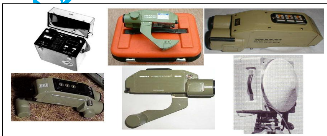
الشكل (41) أنواع مختلفة من أجهزة قياس المسافات الكترونياً (EDM)
