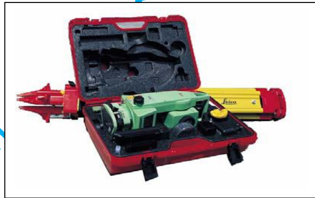
الشكل (32) طريقة رزم جهاز المحطة المتكاملة في حقيبته الخاصة
