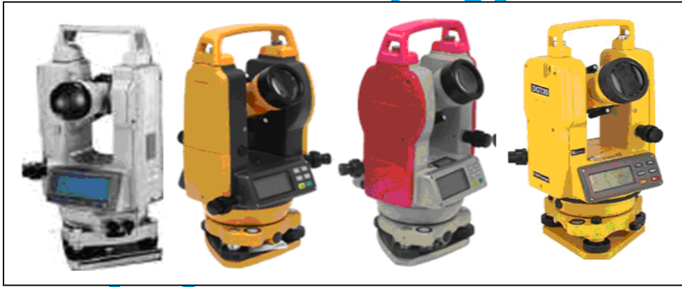
الشكل (١١) أجهزة الثيودوليت الرقمية (Digital Theodolite) صينية الصنع
