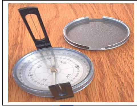
الشكل (2) أشرطة مختلفة لقياس المسافات والبوصلة المغناطيسية المستخدمة بالمساحة
