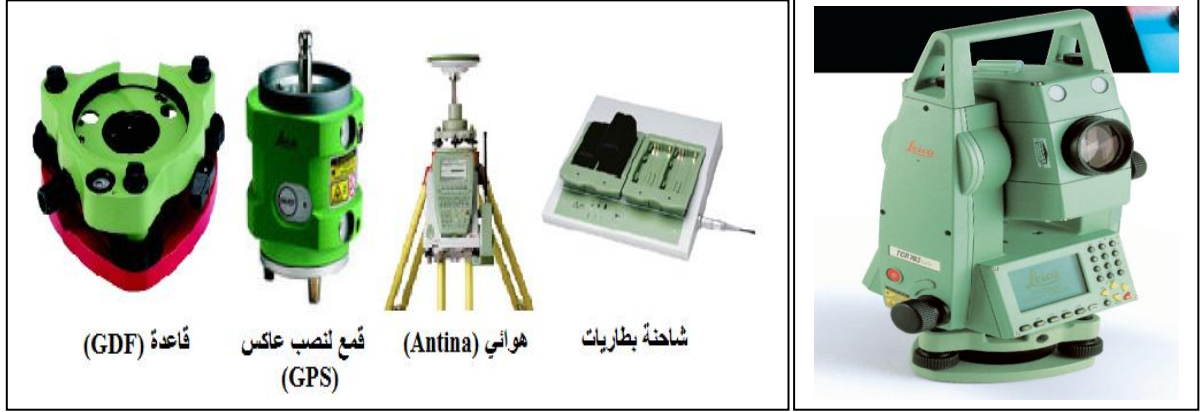
الشكل (27) جهاز لايك السويسرية (T.S) الليزري (TPS 703 TCR) بدون عاكس وملحقاته
