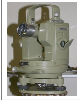
الشكل (14) أجزاء وشكل جهاز الثيودوللايت (المزواة) السويسري نوع ويلد (T16)
