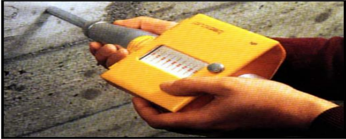
شكل (4): ب- مطرقة مزودة بشريط ورقي لكتابة النتائج
