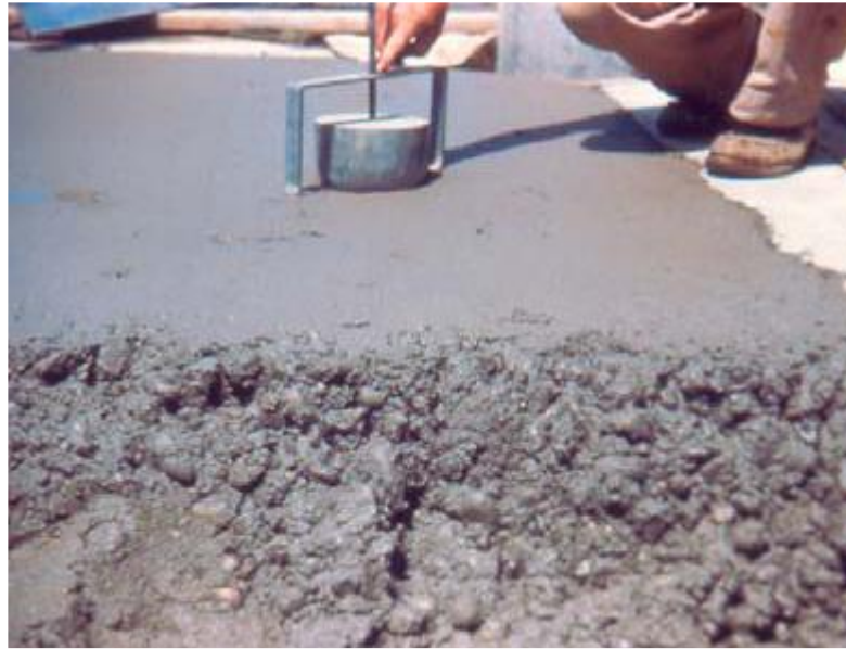
شكل رقم (7-B) جهاز كرة كيلي للاختراق لفحص قوام الخرسانة
