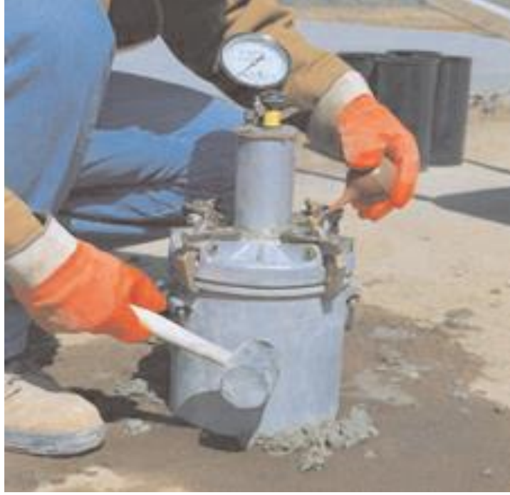
شكل (1-A): جهاز لقياس محتوى الهواء بطريقة الضغط
