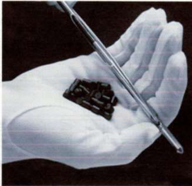
صورة لأقراص اليورانيوم والتي تظهر سوداء في الصورة والتي تعرف باسم الوقود النووي
